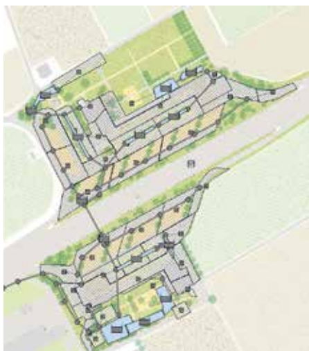
Vue en plan du modèle SWMM de la variante 2
