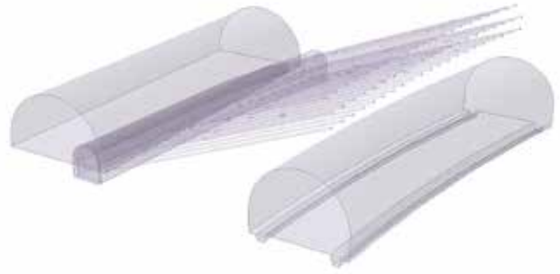
Einfluss der Entlastungsbohrungen auf die Excavation Damage Zone Visualisierung der bestehenden Röhre (vorne) und der 2TG mit den Entlastungsbohrungen
