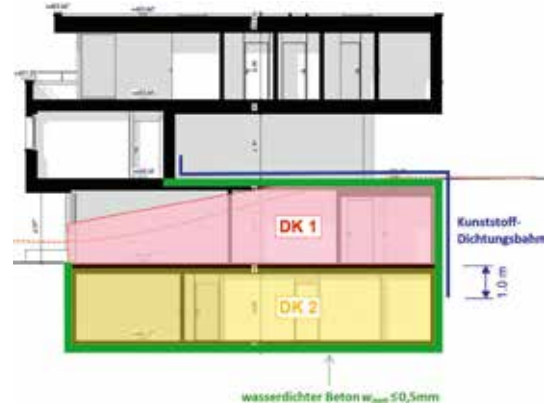
Modell des Gebäudes (links) und Abdichtungskonzept (oben)
