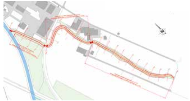
Umlegung des Krebsengrabens
