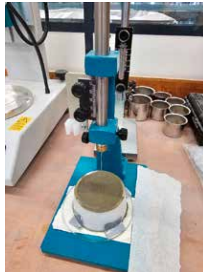
Prüfung der Zementsuspension mit dem Nadelgerät
