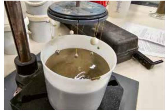
Prüfung der Zementsuspension mittels Kugelharfe zur Bestimmung der Fließgrenze
